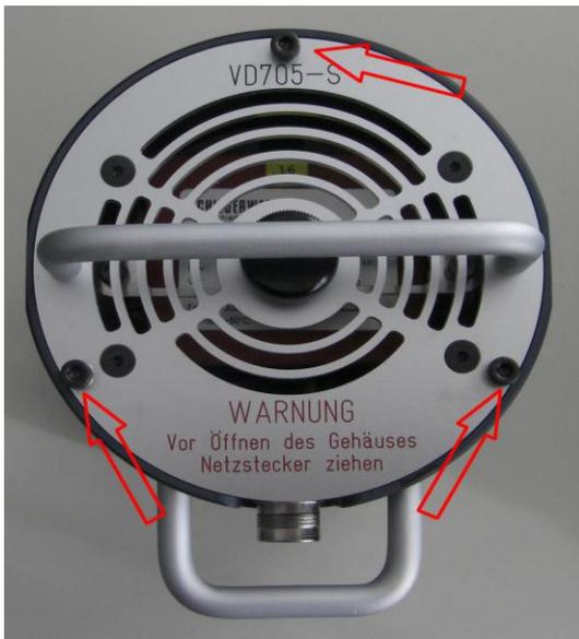
Zum Öffnen Stecker ziehen, die 3 sich auf der Rückseite befindlichen Inbusschrauben entfernen, anschließend kann Leuchte komplett nach hinten herausgezogen werden.
